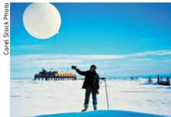
Um dos instrumentos utilizados pelos meteorologistas para obter informações são os balões meteorológicos.
