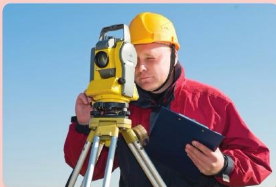
O teodolito, aparelho usado para medidas angulares.
